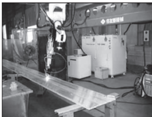
写真4 レーザー溶接の様子 (出典：独立行政法人産業技術総合研究所資料)
