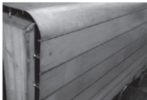
写真6 溶接構造によるエアロトレインモデル構造体 (出典：独立行政法人産業技術総合研究所資料)
