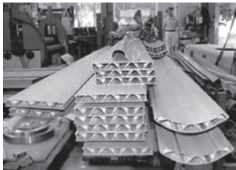
写真 2 拡張押し出し成形加工された部材 (出典：独立行政法人産業技術総合研究所資料)
