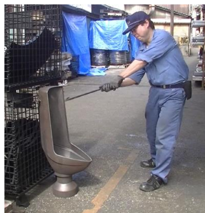
ボールによる打撃試験
