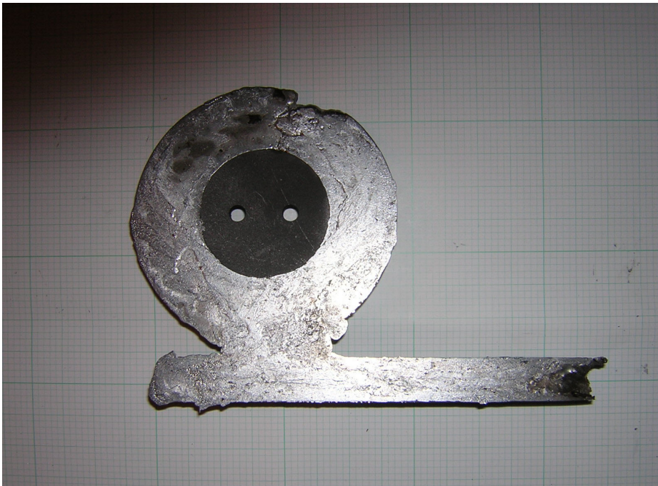
写真 3-6b 円環状鋳型(単ゲート)に充満したアルミニウム合金
