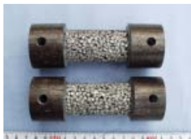
図 1-2-8-9 引張試験片と測定方法
