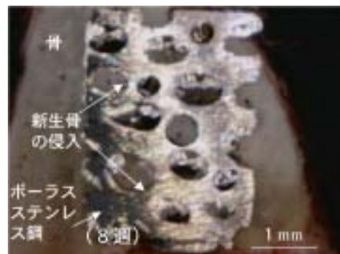
図 1-2-5-13 ハイドロキシアパタイトを 1\mu\text{m} 表面被覆したロータスステンレス鋼をビーグル犬の顎骨に 8 週間埋入後の観察結果：骨組織が開口ポア内に侵入している
