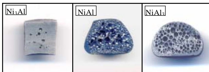
図 1-2-4-2 Ni-Al 系化合物の燃焼合成後の気孔状態 5mm
