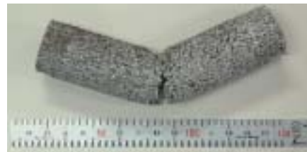
図 1-2-8-12 曲げ試験後の試験片
