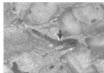
図 1-2-7-7 スペーサー法で作製されたポーラスアルミニウムの変形後の組織
