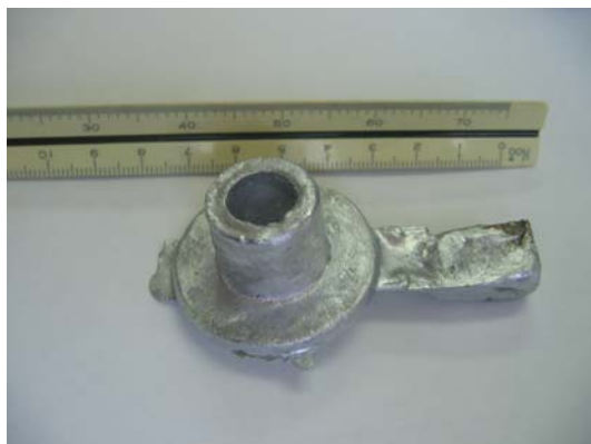
図 3-11 実部品モデル型で試作した鋳物
