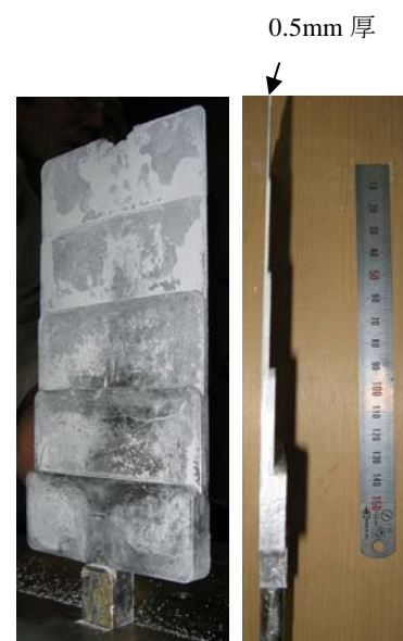
材 質：ADC12 金型温度：室温 先端厚さ：0.5mm
