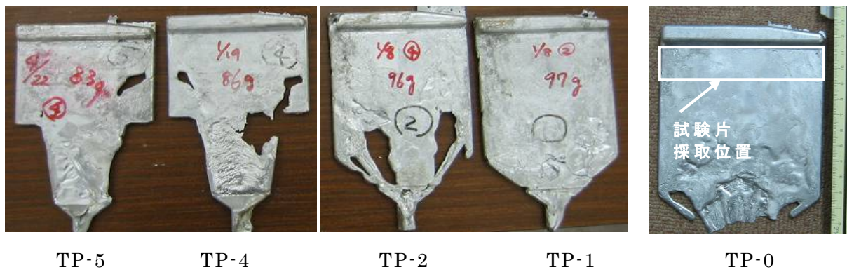
図 3-8 比較的初期に得られた鑄造試験片の外観
