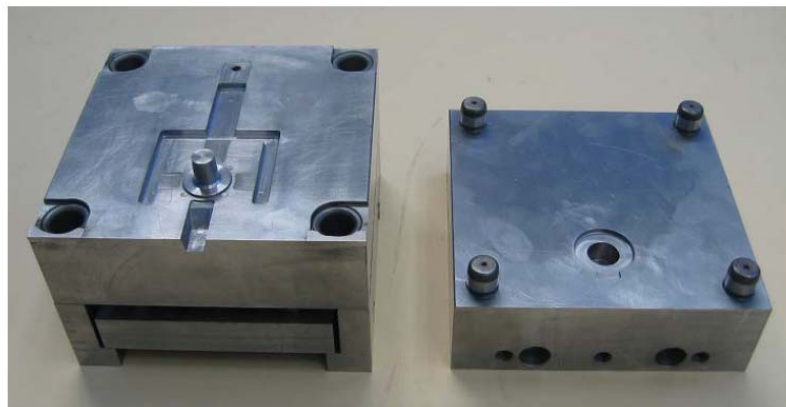
図 2-8 実部品モデル金型
