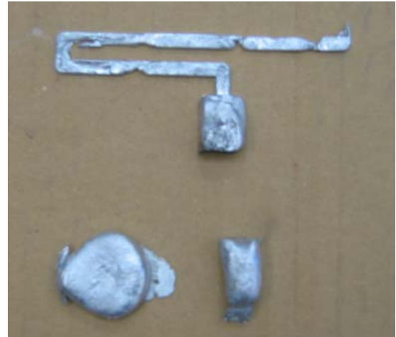
図 3-10 湯流れ試験型で試作した鋳物
