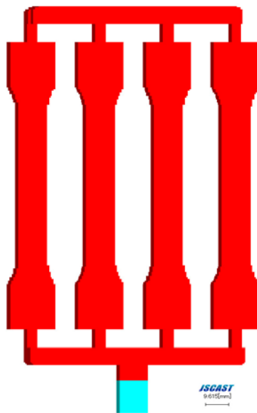
図 4-7 黒鉛鑄型の計算モデル
