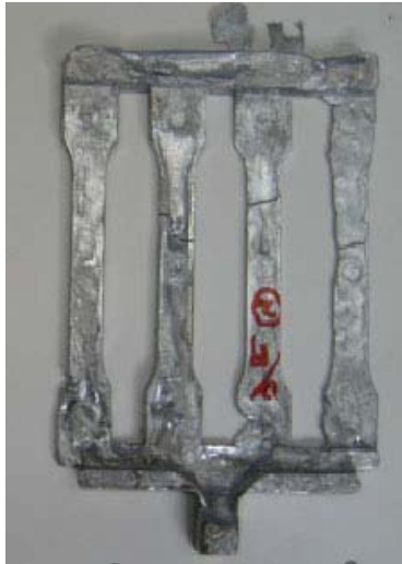
図 3-9 引張試験片型で試作した鋳物
