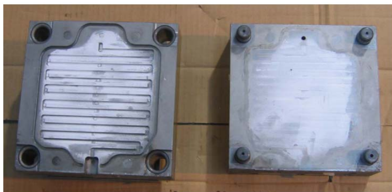
図 2-2 湯流れ試験金型
