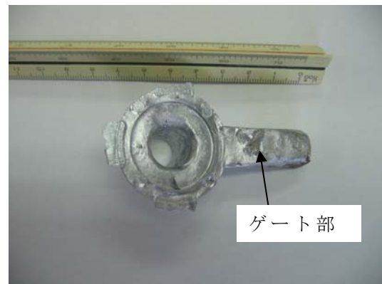
図 3-11 実部品モデル型で試作した鋳物
