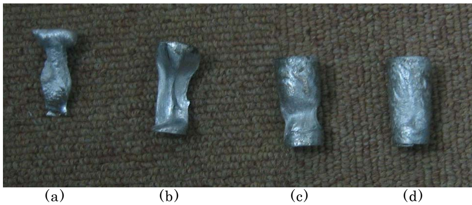
図 3-3 開口部に残留した凝固物
