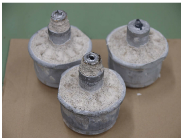
図 3-12 セラミック型で試作した鋳物(外観)
