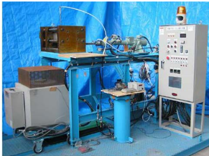
図 1-3 高真空吸引加圧鑄造装置の外観写真
