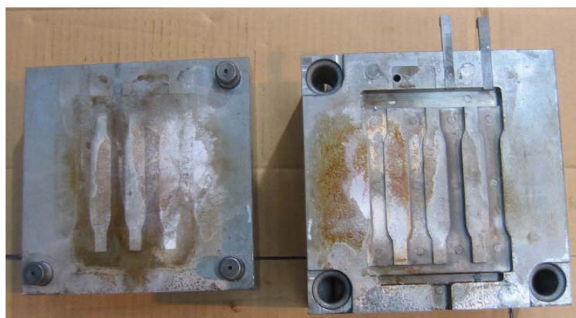
图 2-4 引張試験金型
