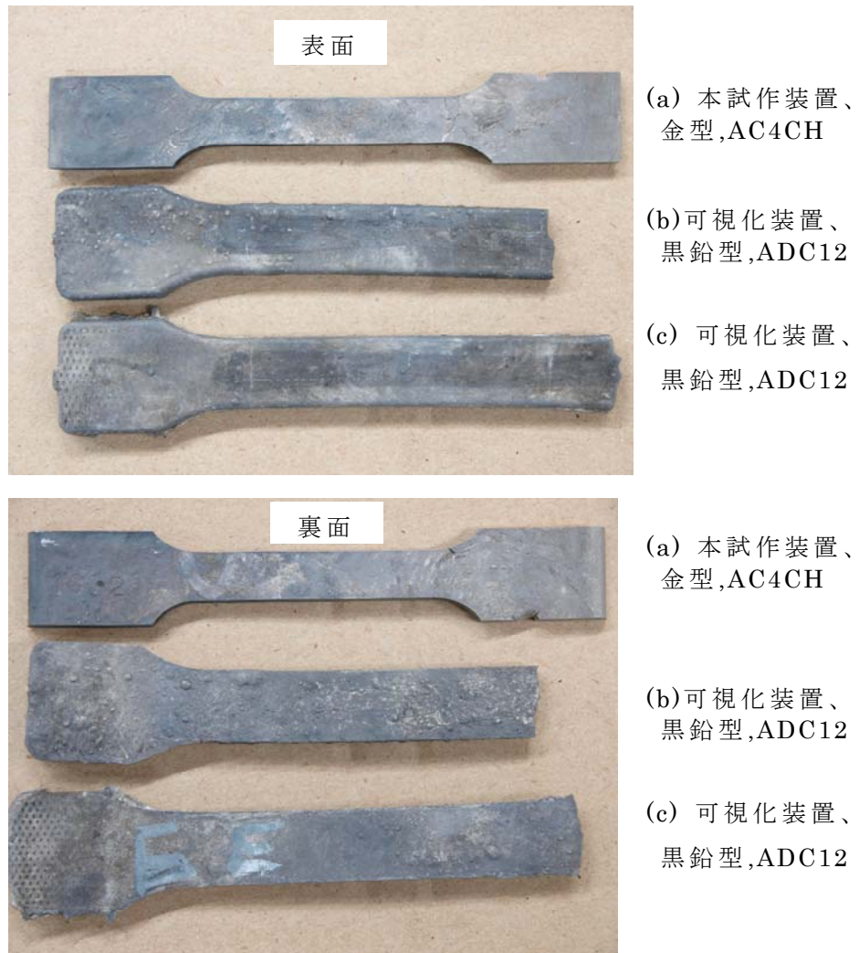
図 3-23 熱処理(T6 処理)によるふくれ
