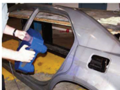
写真1.3.2.5 量産パネルの板厚測定
