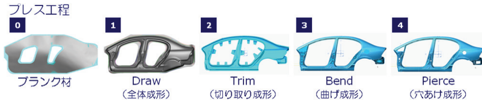
図1.3.2.2 サイドパネルアウターの成形工程
