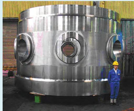
原子力発電所の圧力容器の一部(鍛鋼製)
