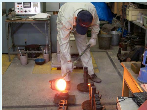
鋳造試験研究室（試験片作成の様子）
