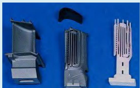
タービン動翼の内部構造
