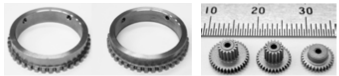
切削加工 (左) と粉末冶金工法 (右) 約50%のコストダウン (φ60)
