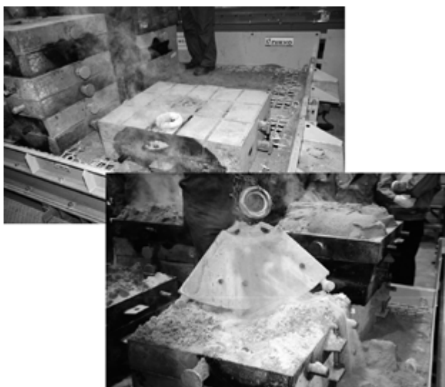
写真4 凍結鑄造の型ばらし
