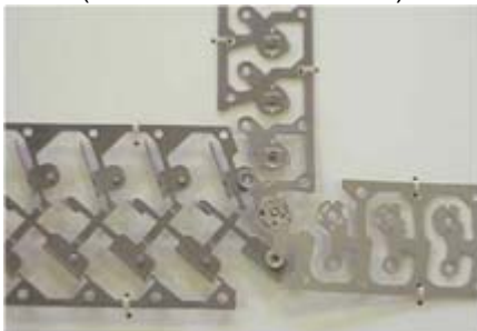
図 1-2-17 プレス加工と結合の複合成形事例 (株セキコーポレーション)
