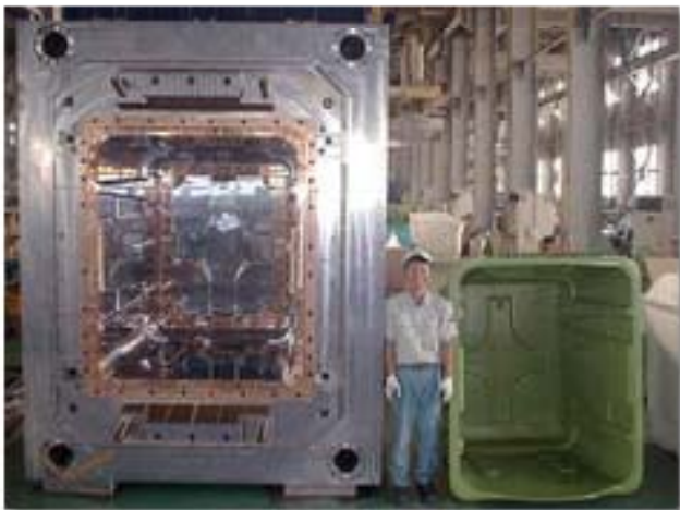
▲ 金型重量215tの射出成形金型
