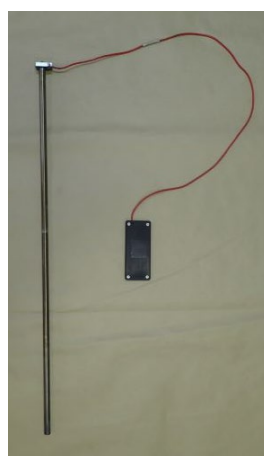
センサー付き押出ピンと無線計測機
